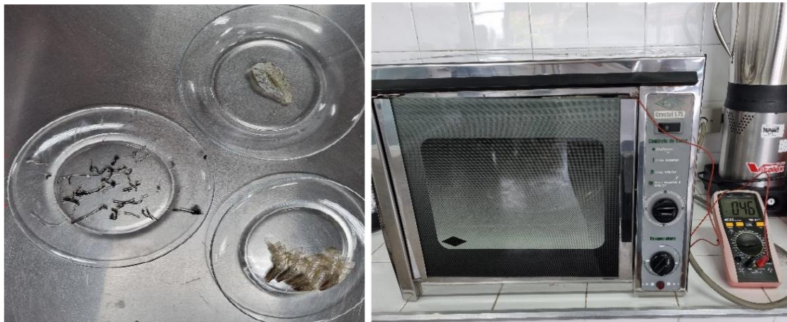
Figura 6. Secagem das amostras
