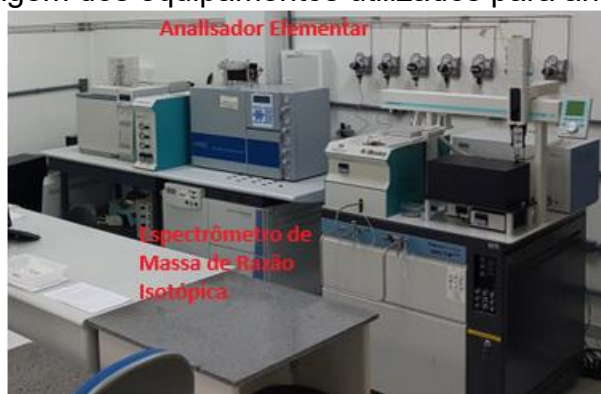
Figura 8. Imagem dos equipamentos utilizados para análise isotópica
