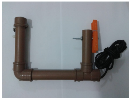
Figura 2 - Foto do fotogate construído. Fonte: Acervo dos autores
