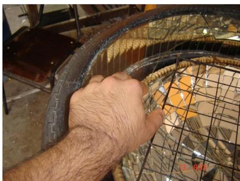
**Figura 12 - Montagem dos componentes internos do forno.**
