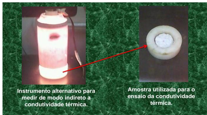
**Figura 5 - Esquema de medição indireta da condutividade térmica do compósito.**
