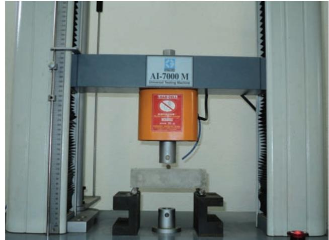
Figura 7 - Ensaio de Tração na Flexão Simples a Três Pontos
