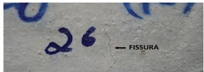
Figura 8 - Fissura em CP após Ensaio de Tração na Flexão
