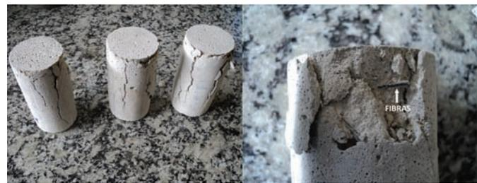
Figura 4 - CP após ensaio de compressão
