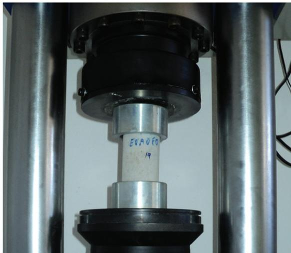
Figura 3 - Ensaio de Compressão
