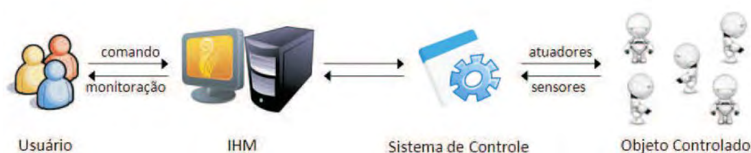
Figura 01. Esquema Geral de um Sistema Mecatrônico
