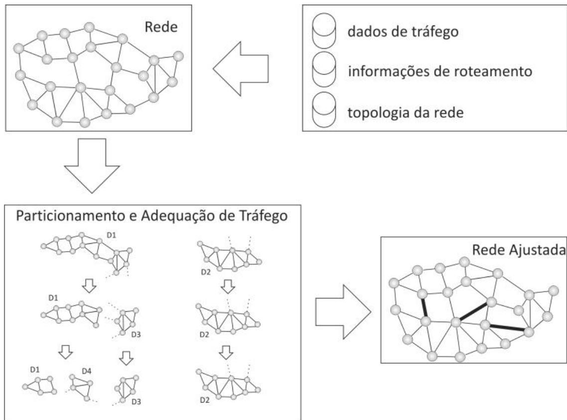
A análise começa recebendo os dados da rede em formato de texto com tabelas. Em seguida, a rede original é construída dentro do simulador. A fase crítica é o particionamento (baseado em densidade) e a consequente verificação de adequação do tráfego nos domínios criados.
