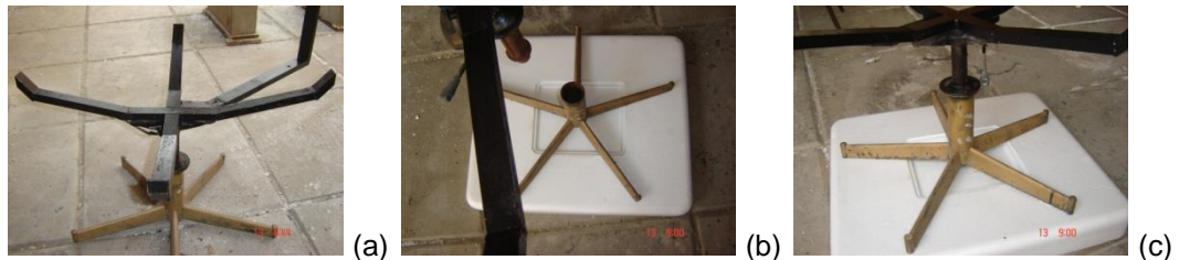
Figura 8 - Estrutura de sustentação do forno/fogão solar.
