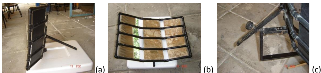
Figura 7 – (a) vista lateral, (b) vista frontal e (c) detalhe do parafuso de fixação para seguimento do movimento aparente do sol.
